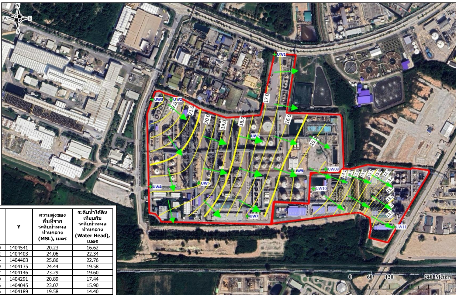
แผนผังแสดงทิศทางการไหลของน้ำใต้ดิน ครั้งที่ 1 ประจำปี พ.ศ.2568 โครงการโรงงานผลิตสารฟีนอล บริษัท พีทีที โกลบอล เคมิคอล จำกัด (มหาชน)
